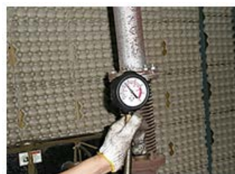
รูปที่ 9 การวัดกำลังอัดกระบอกสูบ
