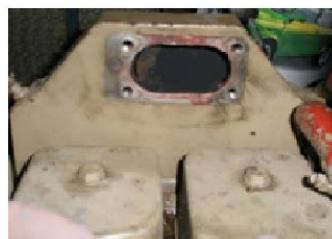
รูปที่ 10 แอร์คูลเลอร์ของเครื่องยนต์
