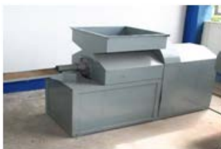
รูปที่ 2 เครื่องอัดแท่งเชื้อเพลิง
