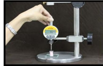
ภาพที่ 8 การนำชิ้นทดสอบเข้าเครื่องวัดระยะดิจิทัล หลังจากทำการทดสอบเพื่อหาความยาวที่เปลี่ยนแปลงไป
