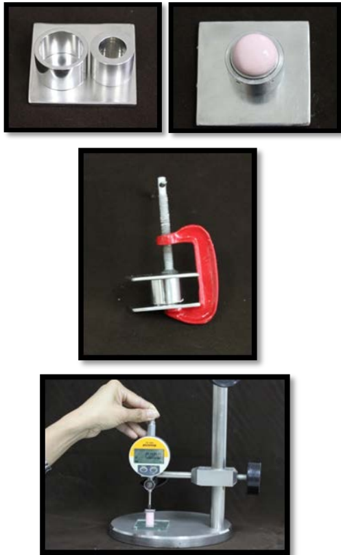
ภาพที่ 7 การนำชิ้นทดสอบเข้าเครื่องวัดระยะดิจิทัล
