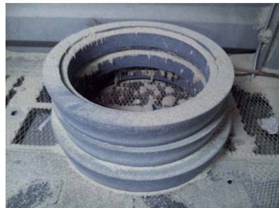
ภาพที่ 2 แสดงลูกหินที่ใช้ขัดข้าวภายในเครื่องขัดข้าวขาว
