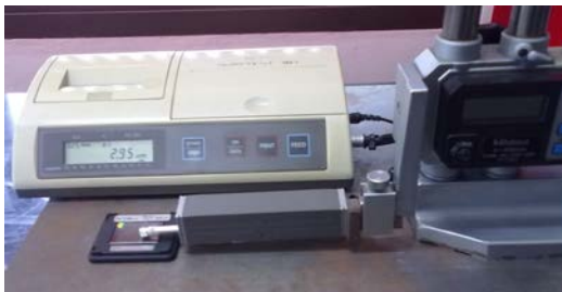
รูปที่ 2 เครื่องมือวัดความหยาบผิว Mitutoyo Surf test 3D ที่สอบเทียบด้วยแผ่นเทียบผิวมาตรฐาน
