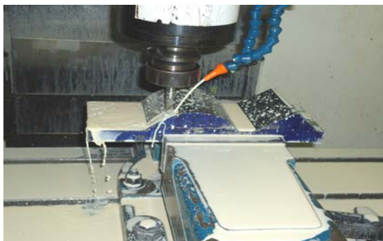
รูปที่ 6 การกัดชิ้นงานรูปร่างตามแบบชิ้นงานที่ออกแบบไว้โดยการใช้เครื่องกัดแบบหยาบ(Roughing Milling) หลังจากนั้นจับยึดชิ้นงานทดลองเข้ากับปากกานบนโต๊ะงานเครื่องกัดอัตโนมัติดังรูปที่ 6 แล้วสุ่มเลือกค่าตัวแปรที่ได้ออกแบบการทดลองไว้แล้วป้อนเข้าเครื่องกัดอัตโนมัติเพื่อกัดชิ้นงานทดลองเพื่อวัดค่าความหยาบผิว
