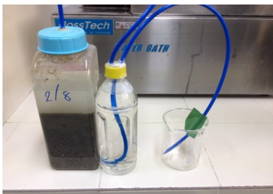
รูปที่ 5 ผสมอัตราส่วนน้ำเสียต่อกากมันสำปะหลัง
