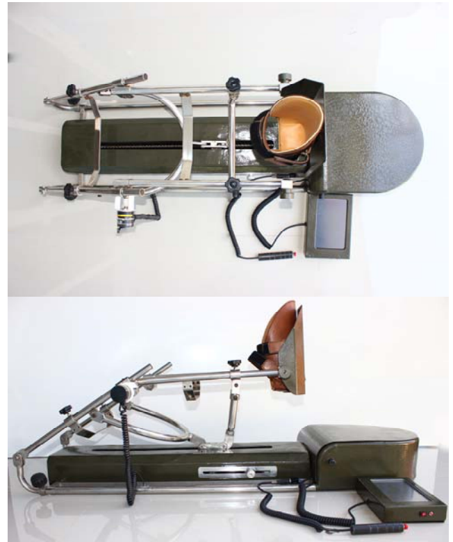
รูปที่ 7 เครื่องช่วยการเคลื่อนไหวข้อเข่าอัจฉริยะที่ถูกพัฒนาขึ้น
