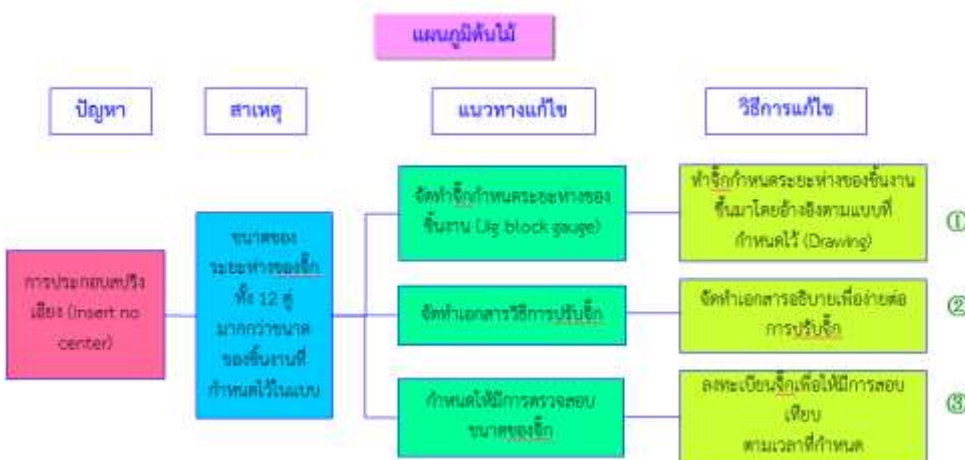
รูปที่ 11 แผนภูมิต้นไม้แสดงถึงแนวทางในการแก้ไขการประกอบสปริงเอียง
