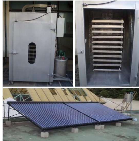
ภาพที่ 2 ส่วนประกอบของตู้อบ โดยใช้พลังงานร่วมระหว่างแสงอาทิตย์และก๊าซปิโตรเลียมเหลว
