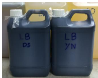
ภาพที่ 7 ลักษณะน้ำมันหล่อลื่นที่ผ่านการใช้งานกับเครื่องยนต์มาแล้ว 300 ชั่วโมง
