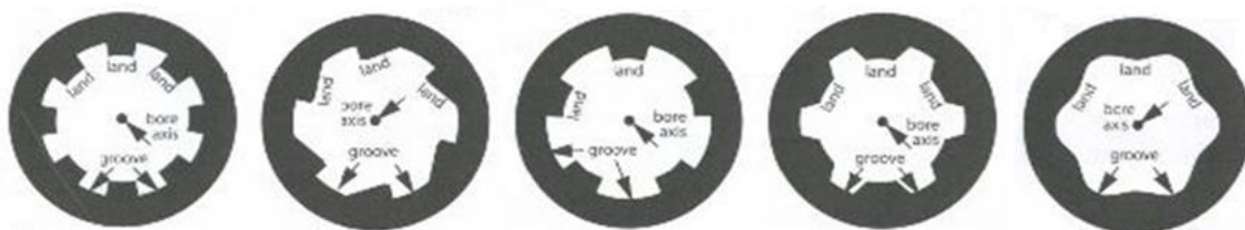
ภาพที่ 2 แสดงร่องเกลียวและสันเกลียวภายในลำกล้องปืนแบบ Conventional Rifling , Ratchet Rifling , Enfield Rifling , Hybrid Rifling , Polygonal Rifling ตามลำดับ (Brian, 2008)
